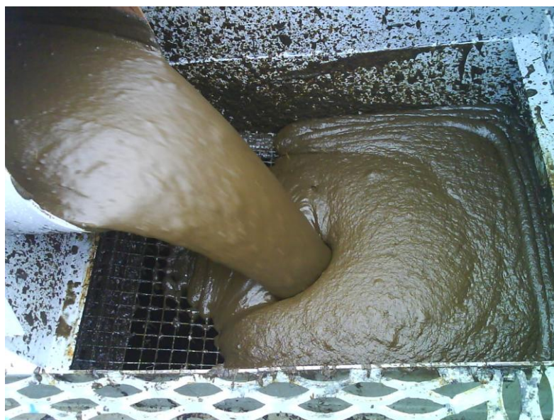
Рисунок 4.45- Подача сапропеля естественной влажности в береговой накопительный бункер по предложенной технологии
