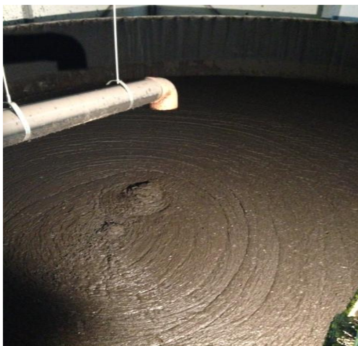
Рисунок 2.24 – Сапропель в береговом бункере емкостью 500м 3 , добытый с помощью полупогружного ГЗУ камерного типа со встроенным ЭВН с гидравлическим приводом на озере Убаговас.
