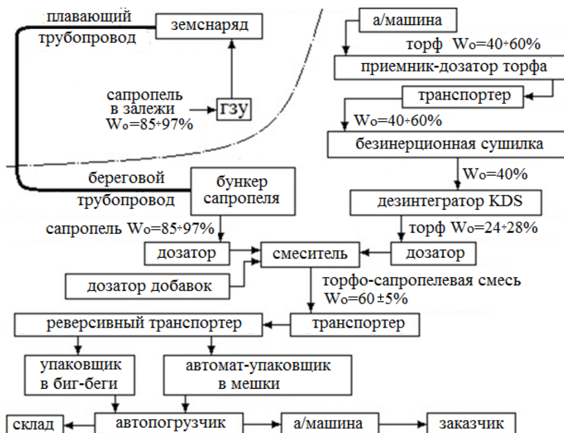
Рисунок 5.2 - Принципиальная технологическая схема производства торфо-сапропелевых удобрительных смесей (ТСС)
