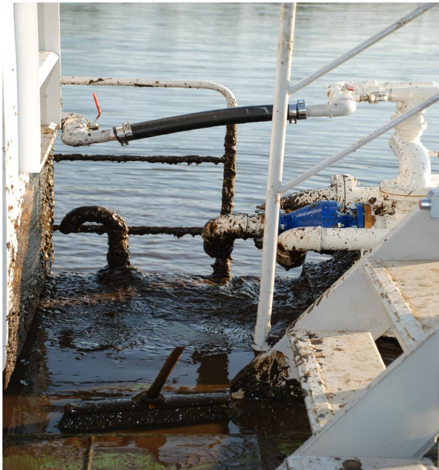
Рисунок 2.17 - Выброс сапропеля из вакуумной системы на палубу земснаряда: сапропель, выброшенный на палубу из выходного патрубка вакуумной системы, поступивший в неё вместе с воздухом из камер насоса.
