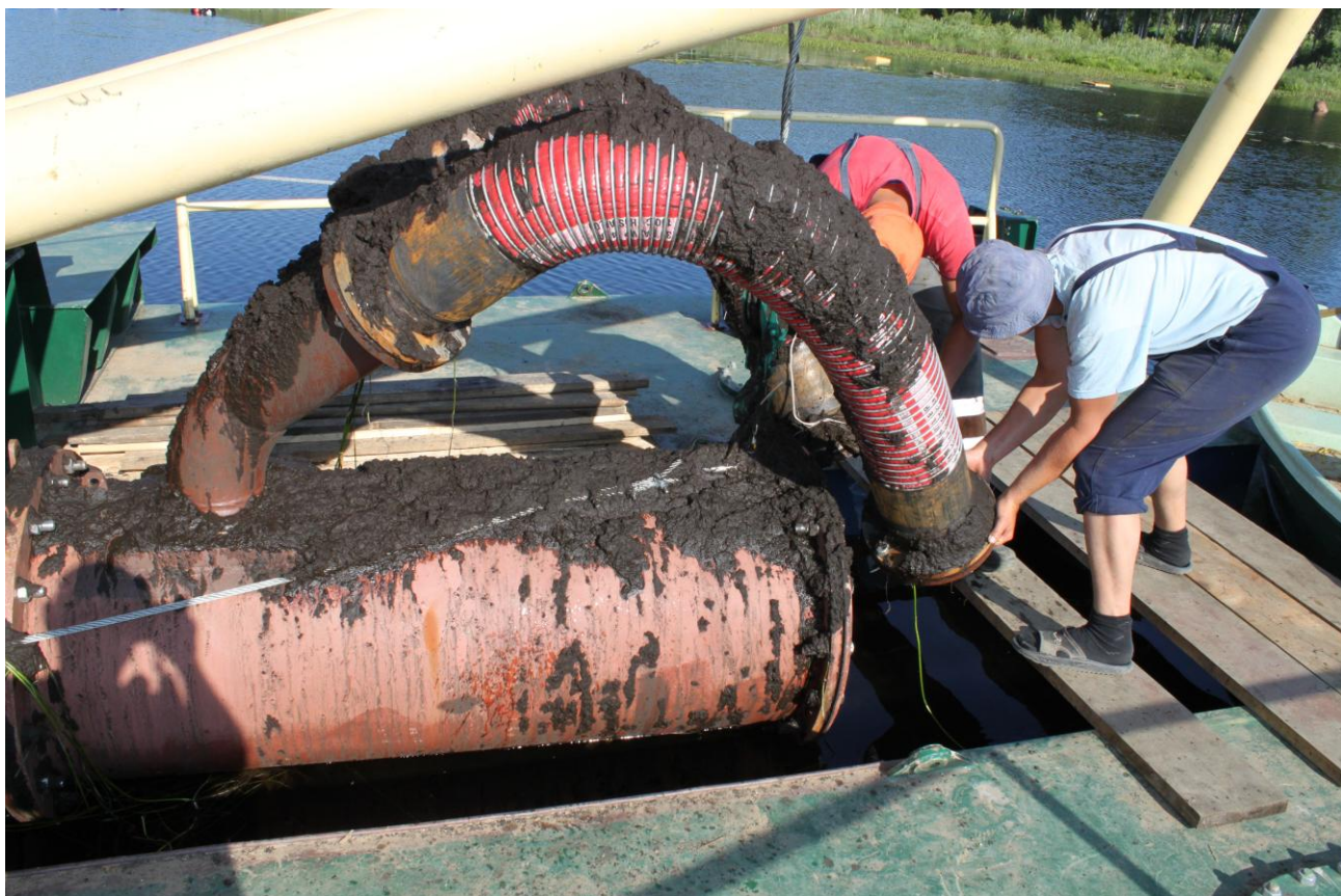
Рисунок 2.26 - Грунтозаборное устройство полупогружной камеры жесткого типа с гибкими всасывающими патрубками и встроенным эксцентриковым винтовым насосом на озере Убаговас в Латвии.
