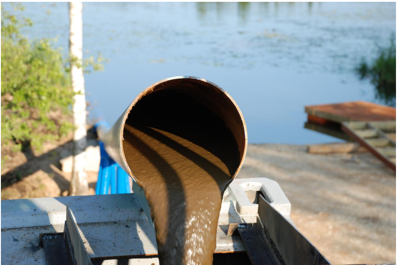
Рисунок 2.19 - Подача сапропеля насосом ПКН в береговой накопительный бункер по напорному трубопроводу диаметром 220мм на озере Веверу.
