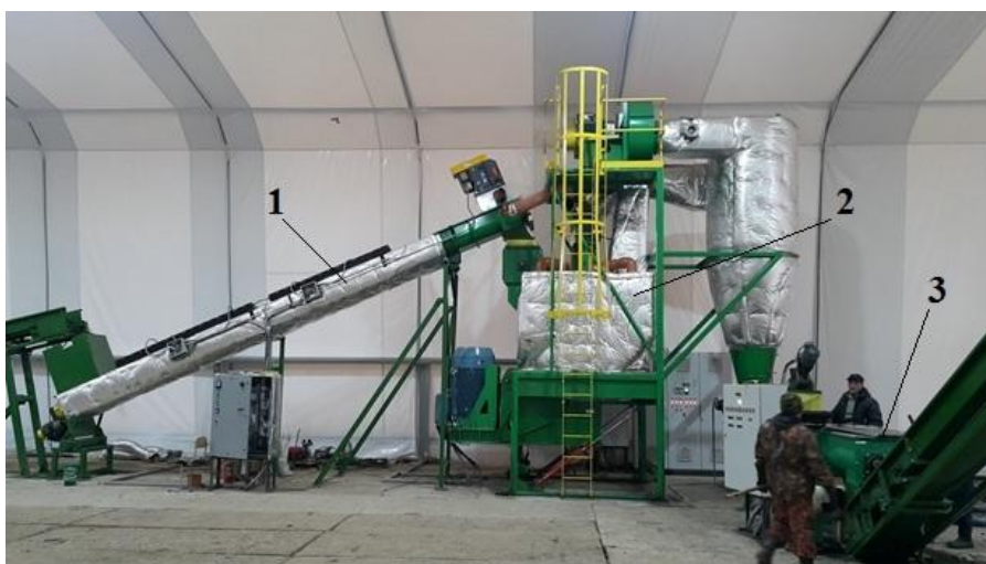
Рисунок 5.3 - Общий вид технологического оборудования на озере Савельево Ярославской области: 1 – транспортер, 2 – КДС, 3 – смеситель.
