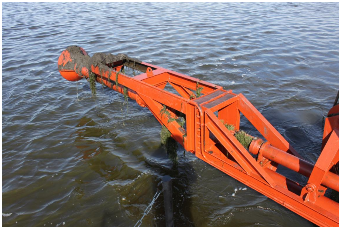
Рисунок 2.6 - Вид шнекового нагнетателя установленного на раме земснаряда 258.60-2СШ.
