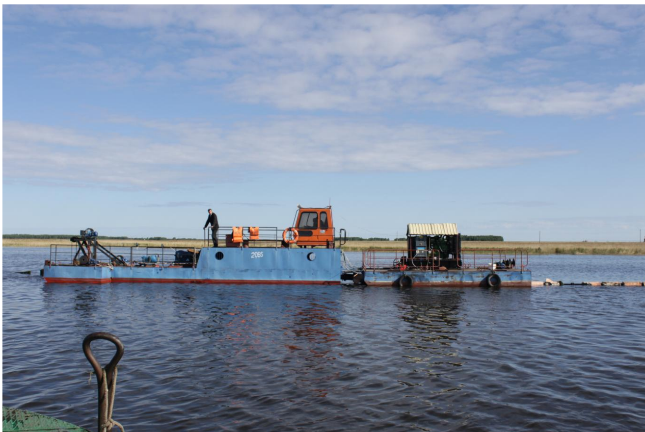
Рисунок 2.4 - Общий вид земснаряда 258.60-2СШ, оборудованного шнековым грунтозаборно-нагнетательным устройством и трюмным ЭВН (село Упорово, Тюмень).
