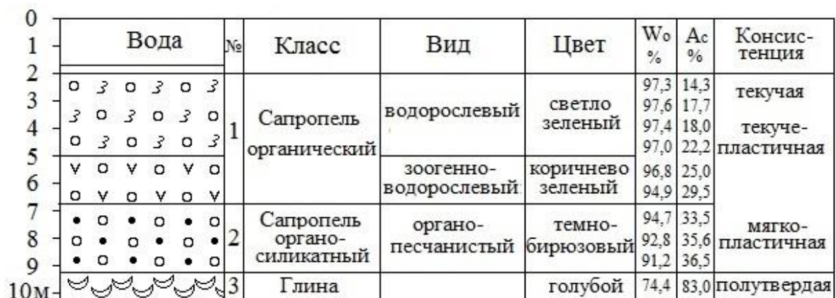
Рисунок 1.2 - Литологический разрез обводненной залежи сапропеля оз. Веверу.
