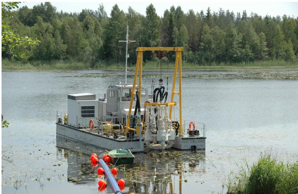
Рисунок 2.16 - Земснаряд на озере Веверу, оснащенный насосом ПКН марки 60/10 итальянской фирмы PNEUMA
